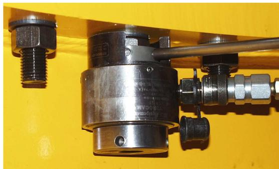
Zur Verwendung dieser Ausrüstung siehe Wartungsabschnitt in der Betriebsanleitung Ihres Krans, in dem die allgemeinen Regeln zum Festziehen von Drehkranzschraubbolzen genau angegeben sind.
