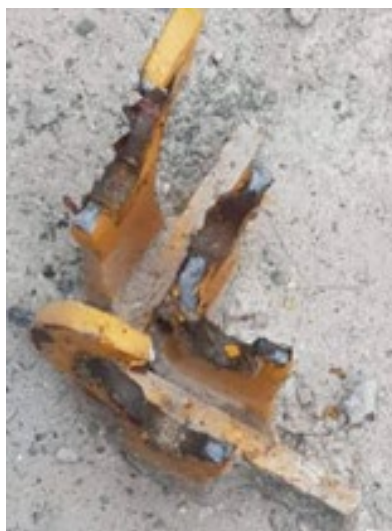
Pata de empotramiento
