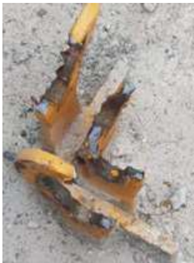
Pata de empotramiento
