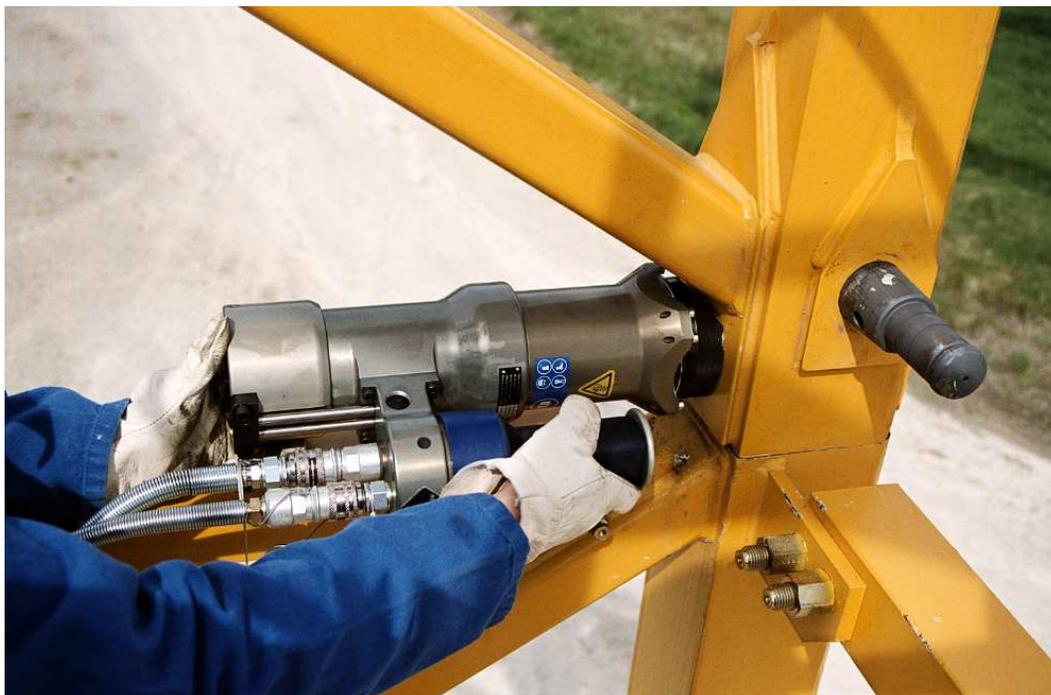
\* Benötigt den Einsatz von Spezialbolzen mit Spannkopf
