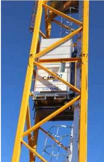
Neuer Innenaufzug für Kranführer, kompatibel mit allen Potain-Mastschüssen vom Typ K (1,6 m, 2 m et 2,45 m) mit neuen oder alten Zugängen.
