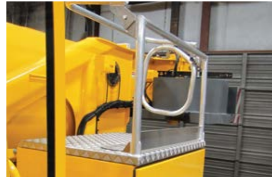
La conveniente plataforma de acceso al malacate ofrece una mayor accesibilidad a las áreas de servicio.
